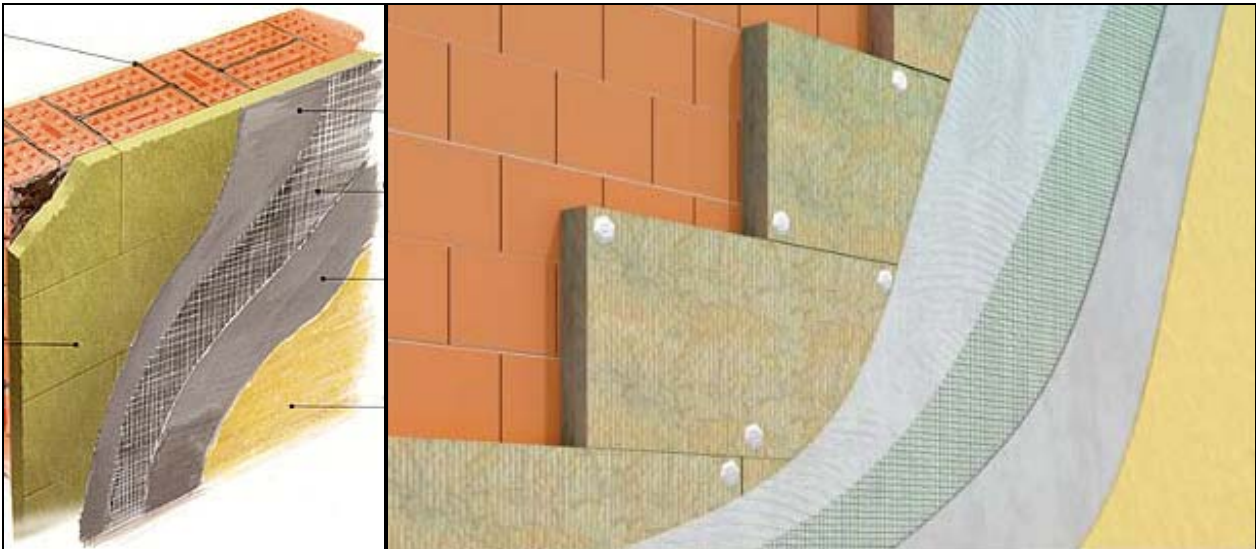
Intervento per l'isolamento dei ponti termici costituiti da travi e pilastri (cappotto esterno)
