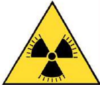
Rischio di irraggiamento
