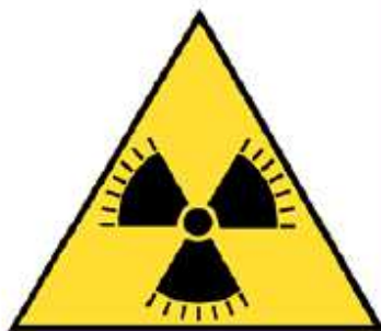
Rischio di irraggiamento
